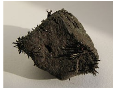
Blocco di magnetite con limatura di ferro attaccata
